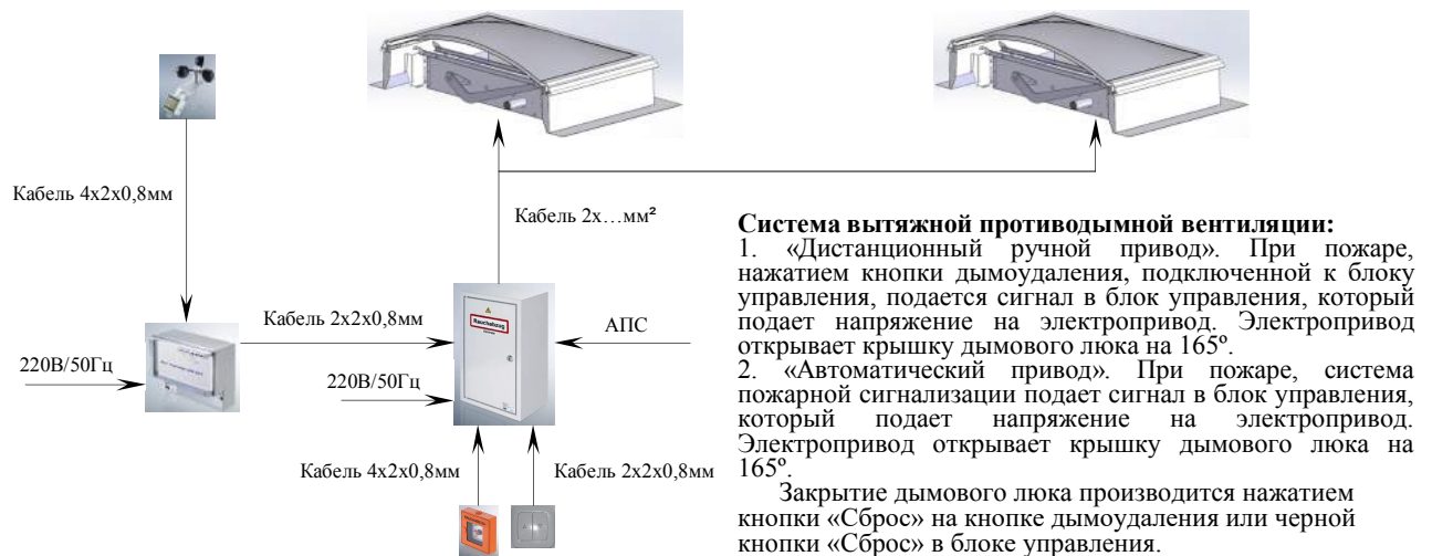
Рис. 2 Схема работы панели управления 24В и 48В
