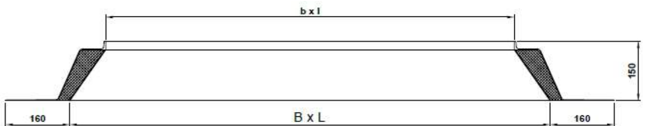
Рис. 2 Основание из стеклопластика, высота 150 мм*
